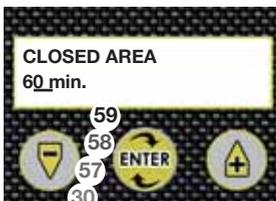
7. Нажмите “START/PAUSE” (B) для выхода из меню и включите робота. Через установленное время робот остановится рядом с ограничительным проводом.
