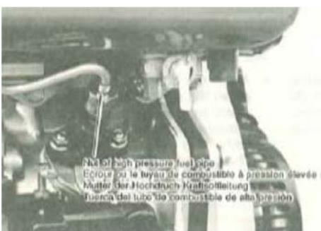
Гайка топливопровода высокого давления
