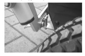
Протяните поворотный рычаг за ручку через петлю на правой стороне машины, а затем подведите его к болтам винтовой нарезкой, расположенным на крышке щётки. Сверху и снизу места крепления металлические находятся шайбы. Вверху расположена пластмассовая шайба. С помощью которой фиксируется самостопорящаяся гайка, закручивается не плотно, свободно.
