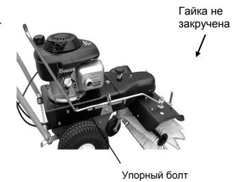
Внизу опорной планки необходимо закрутить болт M6x20 со самостопорящейся гайкой (как изображено на рисунке), при этом резьба направлена к машине. Этот болт служит в качестве упора.
